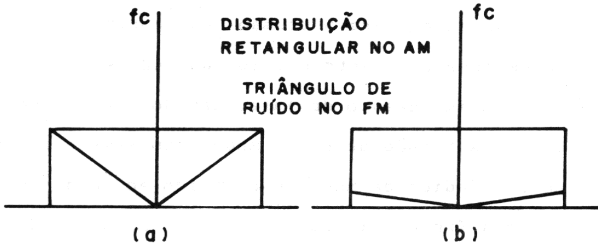
Figura 06 - Distribuição do ruído na faixa - Triângulo de ruído. a - valor máximo m_f = 1,0
