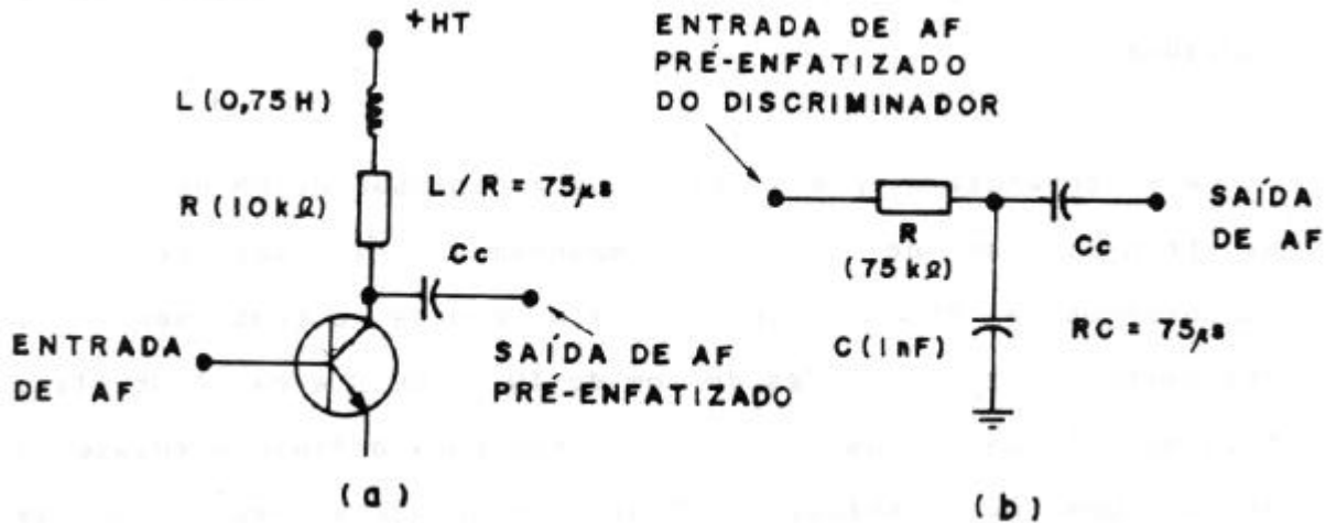
Figura 07 - Circuito de ênfase de 75 μs
